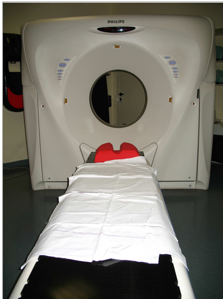
Slika 3.6: CT naprava Philips Mx8000 Dual slice, ki jo uporabljajo na Onkološkem inštitutu v Ljubljani.
